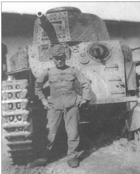
Танки «тип 89» позднего выпуска часто обозначали как «2594». Обратите внимание - пулемет и рубка механика-водителя поменялись местами по сравнению с танками ранних серий.
