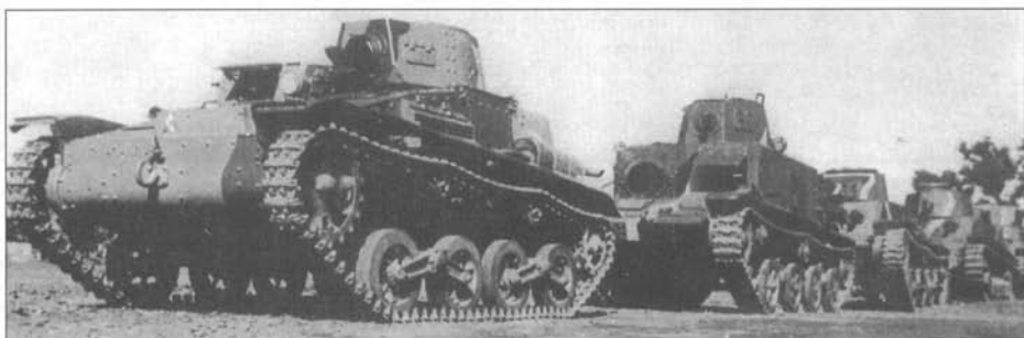
Показ бронетехники в день Армии, 1935 г. Головная машина - танкетка «тип 94» раннего выпуска, за ней стоит машина поздней постройки (опорные катки увеличенного диаметра), на втором плане - кавалерийский танк «тип 92».
