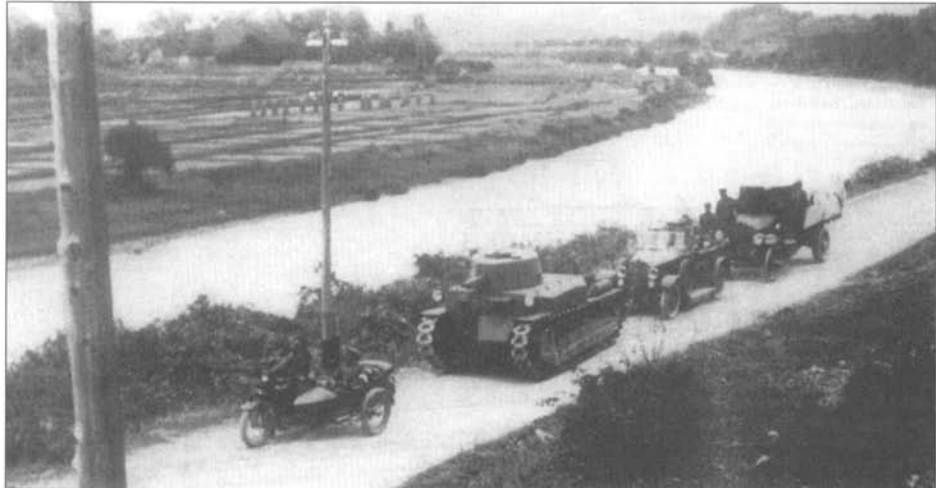
Один из первых серийных танков «тип 89» сопровождает автоколонну в Китае. Обратите внимание на гусеничные траки раннего типа. Башенный люк открыт.
