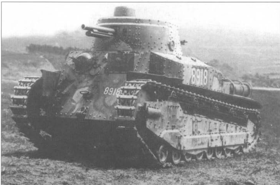
Модернизированный танк «2589 тип 89А Чи-ро» с плоским лобовым бронелистом корпуса. Обратите внимание на незакрытые кожухами стволы 6,5-мм пулеметов «тип 91», один - в лобовом бронелисте корпуса, второй - в корме башни. Корпус танка модернизирован, но ходовая часть с пятью поддерживающими гусеницу роликами характерна для машин ранней постройки.
