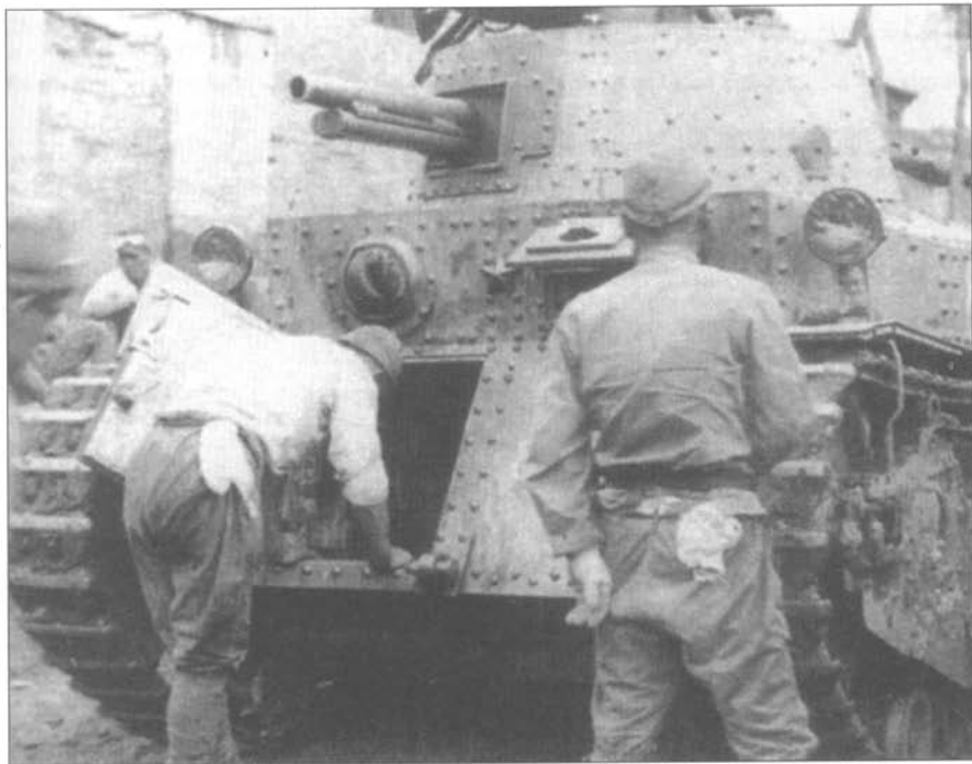
Промежуточный вариант танка «тип 89В» со ступенчатой лобовой частью корпуса и модернизированной башней.
