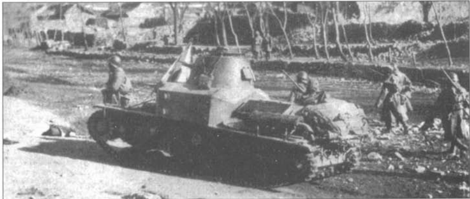
Легкий кавалерийский танк «тип 92 Кей Синша». Ходовая часть соответствует машине раннего выпуска - шесть опорных катков и три поддерживающих гусеницу ролика.
