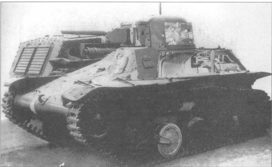
Еще один снимок разведывательного танка «тип 97». Вероятно эта машина использовалась в военном училище в качестве наглядного пособия - снята часть брони, интересен светлый опорный каток.
