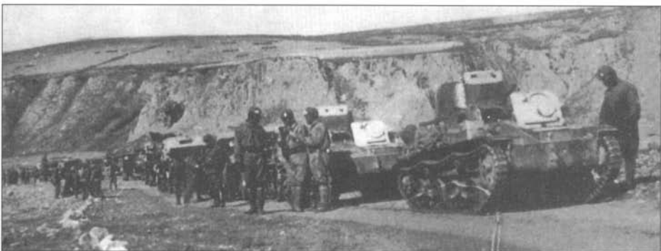
Колонна танкеток «тип 94» в Большом Хингане. На затяжных подъемах двигатели боевых машин сильно грелись - обратите внимание на открытые для улучшения охлаждения движков люки моторных отделений.
