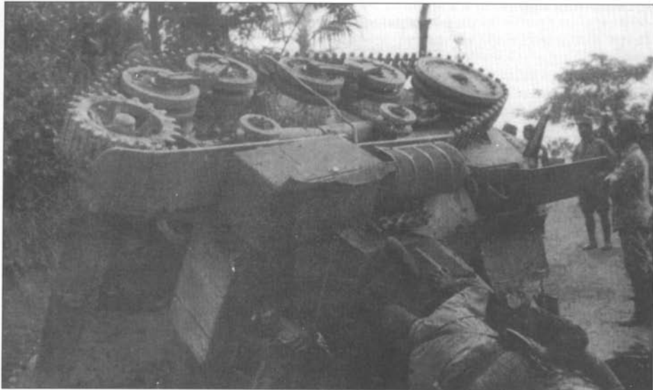
Перевернувшийся командирский танк «тип 97». Открыт люк доступа к трансмиссии и тормозным устройствам.
