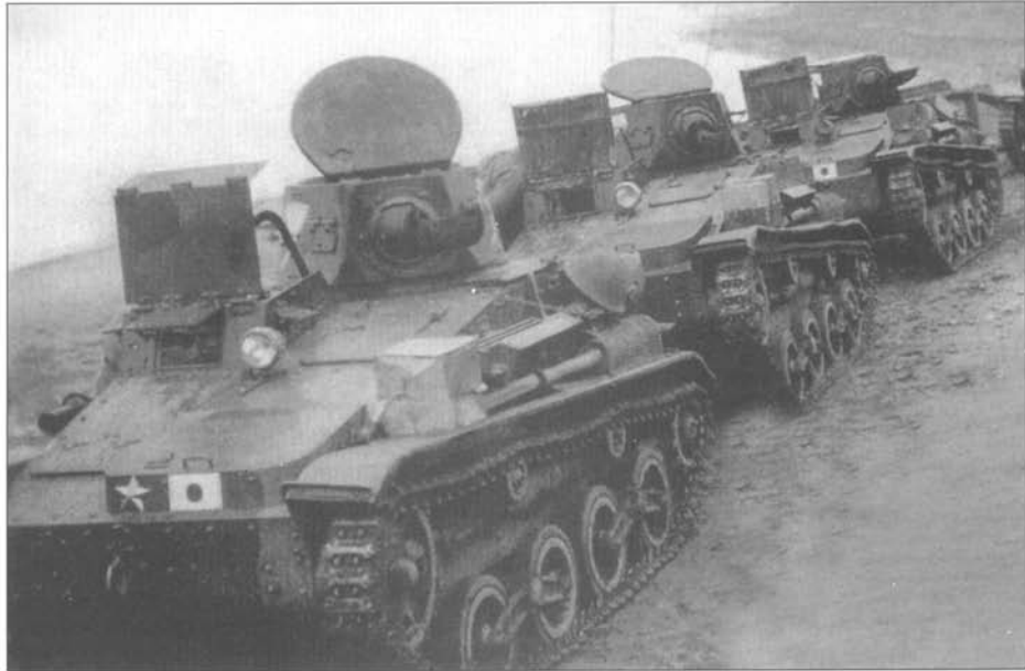
Колонна танкеток «тип 94» в Китае. На снимке хорошо видна маркировка и камуфляжная окраска головной машины. Обратите внимание на форму верхнего люка механика-водителя. Стволы пулеметов зачехлены.
