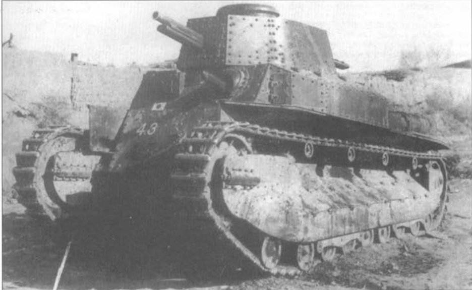
Танк «тип 89» («2594») поздней постройки, снимок сделан на учениях в Китае. Обратите внимание - курсовой пулемет расположен слева, рубка механика-водителя - справа. На танках первых выпусков было все наоборот.
