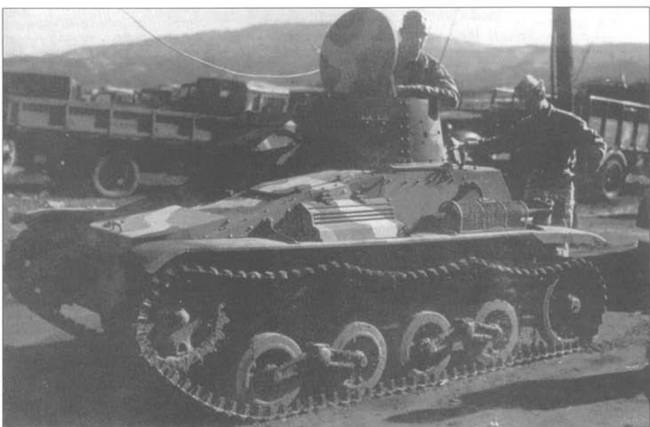
Танкетка «тип 94» раннего выпуска. Машина модернизирована - установлены опорные катки увеличенного диаметра, новый ленивец, бронированный кожух на ствол пулемета, и укороченная выхлопная труба.
