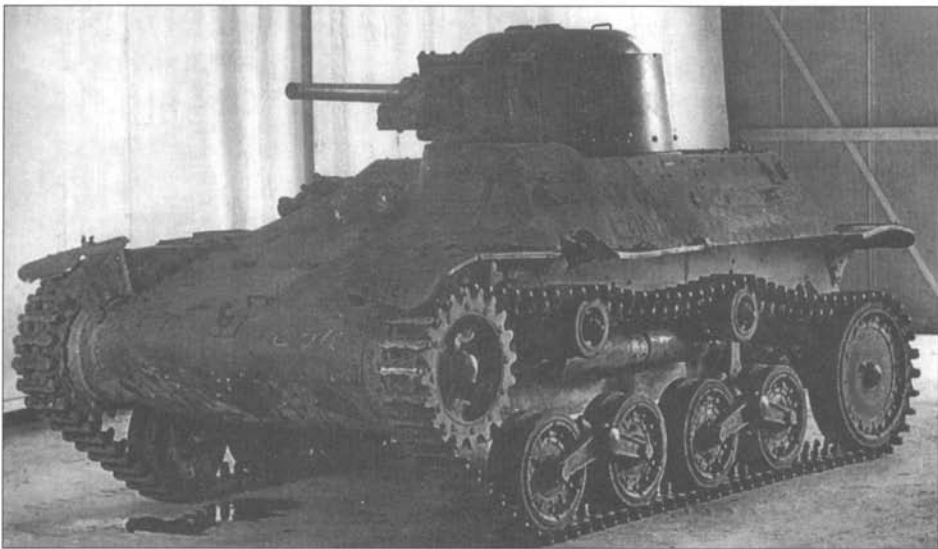
Разведывательный танк «тип 97» - дальнейшее развитие машин «тип 92/94». На танке стоял дизельный двигатель.
