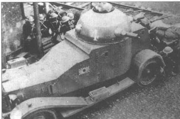
Броневомобиль Виккерс-Кроссли на улице Шанхая. Эти машины чаще всего использовались подразделениями Императорского военно-морского флота. Длина машины - 5,02 м, ширина - 1,87 м, высота - 2,58 м. Мощность двигателя - 50 л.с. Максимальная скорость - 65 км/ч. Вооружение - 2х7,7-мм пулемета.
