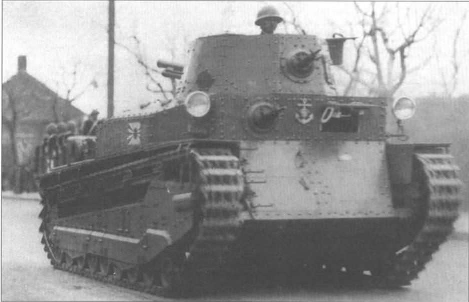
Модернизированный средний танк «тип 89» раннего выпуска - гусеница с мелкими траками. На вертикальном лобовом бронелисте корпуса укреплен эмблема - якорь с хризантемой, на борту изображен флаг ВМС Японии. Армейские машины несли вместо якоря изображение золотой звезды. Башня танка развернута - пулемет смотрит вперед, пушка - назад.
