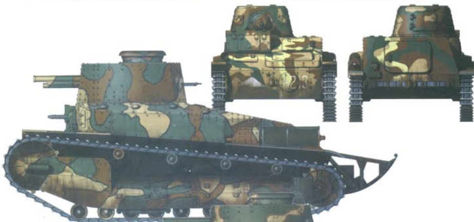
Танк «тип 89А» поздней постройки. Подобная схема камуфляжной окраске использовалась в горных районах Северного Китая.
