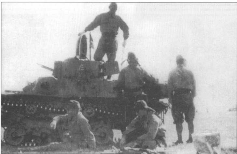
Командирский танк «тип 97», Китай. Вместо пушки в башне командирского танка устанавливался 7,7-мм пулемет.
