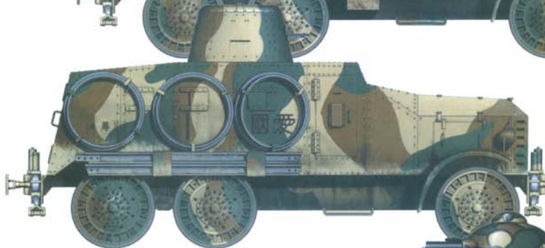
Броневомобиль «Сумида тип 2593» поздней постройки с широким кузовом в шоссейной конфигурации, Китай, 1937 г. Укрепленные на борту железнодорожные рельсы играют роль навесной бронезащиты.
