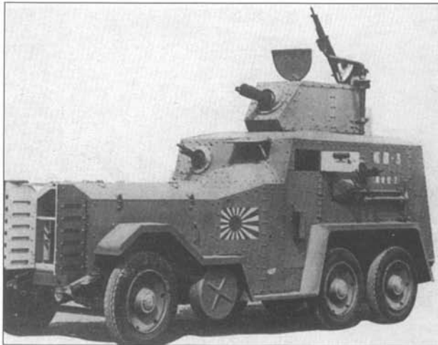
Броневомобиль «тип 92» позднего выпуска. Машина принадлежит подразделению морской пехоты ВМС Японии. Обратите внимание на дополнительное металлическое колесо (сразу за передней осью), предохранявшее машину от посадки на брюхо при движении по сильно пересеченной местности.
