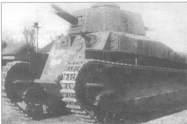
Танк «тип 89» («2594») поздней постройки, снимок сделан на учениях в Китае. Обратите внимание - курсовой пулемет расположен слева, рубка механика-водителя - справа. На танках первых выпусков было все наоборот.
